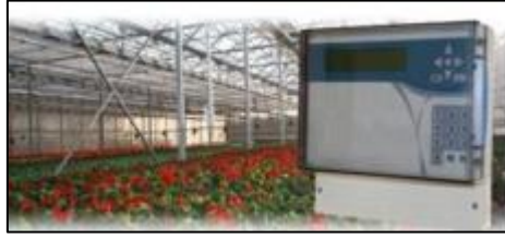
Şekil 8.29 Sera İklim Kontrol Sistemi[7]
